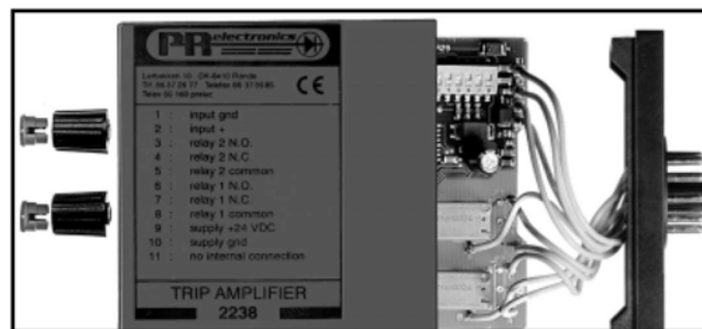
Рис. 3: Извлечение платы для изменения положений переключателей и перемычек
